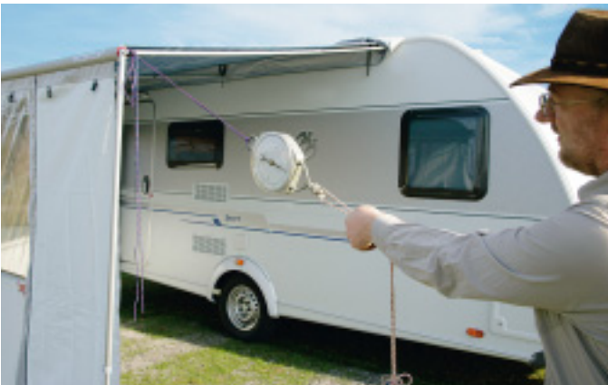
Auf dem Prüfstand: Markisenzelle von Fiamma, Thule Omnistor, Herzog und Wigo. Zwei baugleiche Caravans Knaus Sport stellen die Basisfahrzeuge. Bewertet wurden Stabilität, Aufbau, Verarbeitung, Material und Dichtigkeit.
