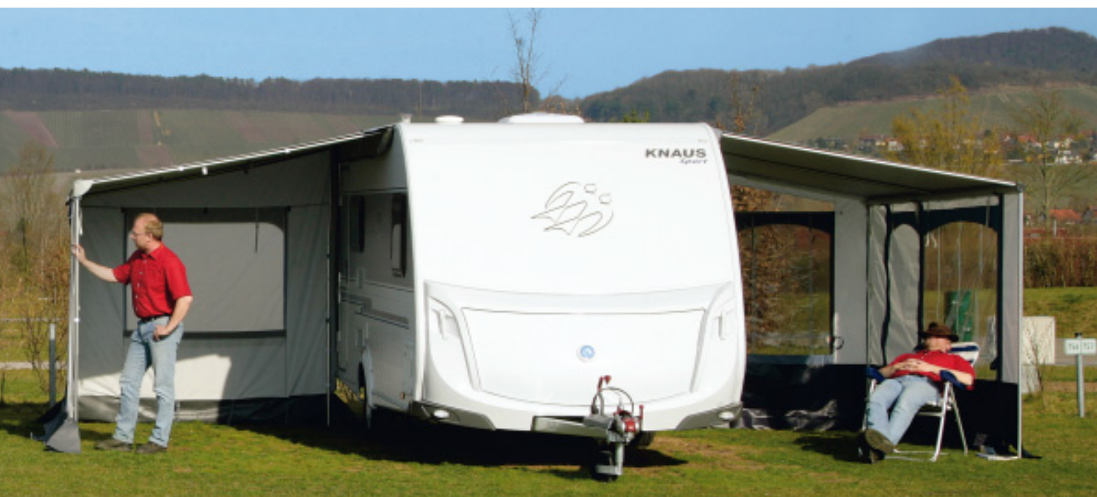
Auf dem Prüfstand: Markisenzelle von Fiamma, Thule Omnistor, Herzog und Wigo. Zwei baugleiche Caravans Knaus Sport stellen die Basisfahrzeuge. Bewertet wurden Stabilität, Aufbau, Verarbeitung, Material und Dichtigkeit.
